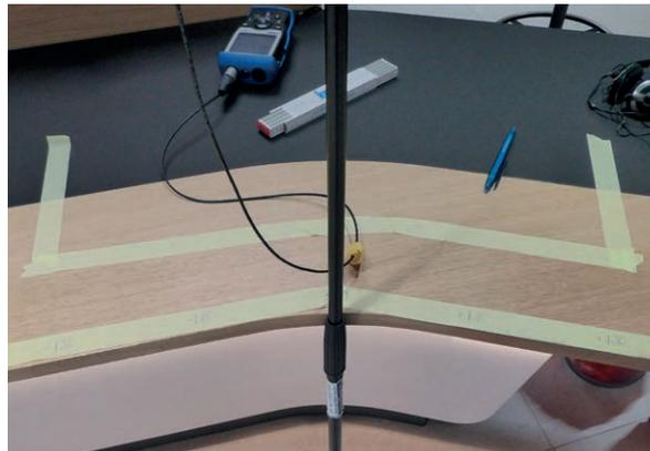
Abbildung 2: Tischplatte in der unteren Position, Markierung der Ringschleife und der seitlichen Messpositionen in 15-cm-Abständen
