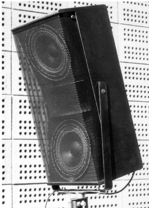
Abbildung 8.2: Relativ kleiner Kompaktlautsprecher guter Qualität. In der Mitte befindet sich ein Hornlautsprecher für die mittlere und hohe Frequenzen. Die Konuslautsprecher oben und unten strahlen Schallenergie bei tiefen und mittleren Frequenzen ab. BxHxT: 24x53x20cm.
