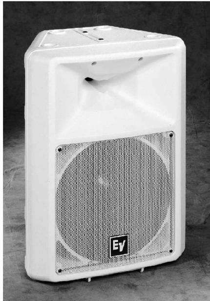
Abbildung 8.3: Anderer typischer Kompaktlautsprecher mit im Hochtonbereich kontrollierter Richtcharakteristik. Oben befindet sich ein Hornlautsprecher, unten ein Konuslautsprecher. Die hohen Frequenzen werden oben, die tiefen unten abgestrahlt. BxHxT: 43x59x31cm.
