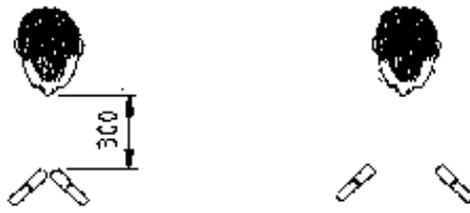
Abbildung 8.17: Richtige (links) und falsche (rechts) Anordnung von zwei Mikrofonen auf einem Rednerpult.
