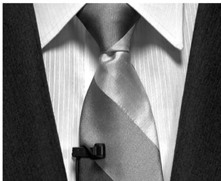
Abbildung 8.13: Ansteck- oder Lavalier-Mikrofon für Funkübertragung. Der Funk-sender wird z.B. am Gürtel angehängt.
