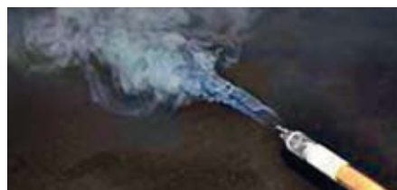
Abbildung 13: Strömungsprüfröhrchen mit Rauchschwaden
