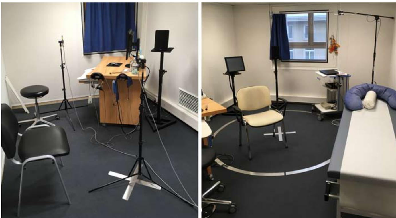
Abbildung 4: Links: Kleine Hörprüfkabine; Rechts: Große Hörprüfkabine (auf den Fotos sind zusätzlich zur Raumeinrichtung die Messmikrofone der Schallpegelmessungen zu sehen)
