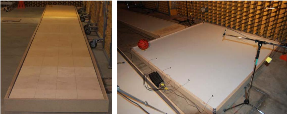
**Bild 5.6** Links: Bodenausschnitt mit 1 m x 10 m im Halb-Freifeldraum zur Messung der Schwingungsausbreitung entlang des Bodens
