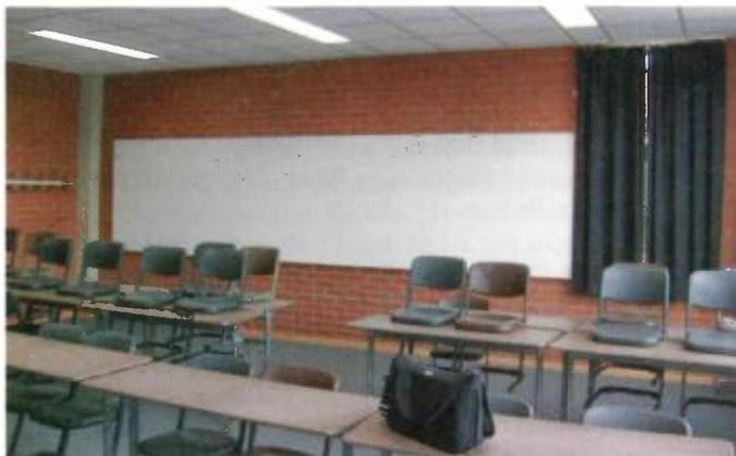
Abbildung 3: Akustisch sanierter Klassenraum, harte Deckenplatten unter Beibehaltung des Tragschienensystems gegen hochgradig absorbierende ausgetauscht, schallabsorbierendes Rückwandpaneel zusätzlich angebracht, Kugelgarn-Teppichboden
