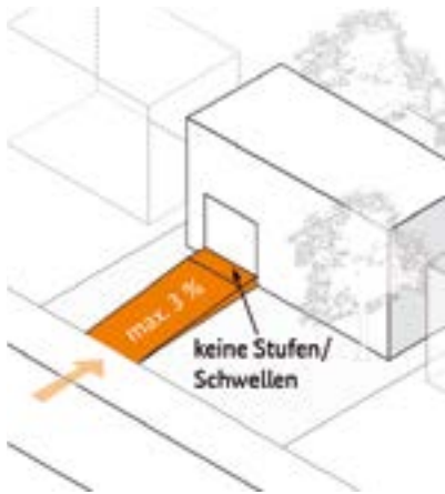
Topografische Situation zur barrierefreien Erreichbarkeit von Eingängen
