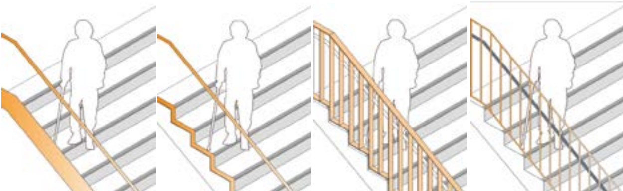
Maßnahmen gegen das Abrutschen von Gehhilfen als seitliche Aufkantung, Wangenform und Geländer
