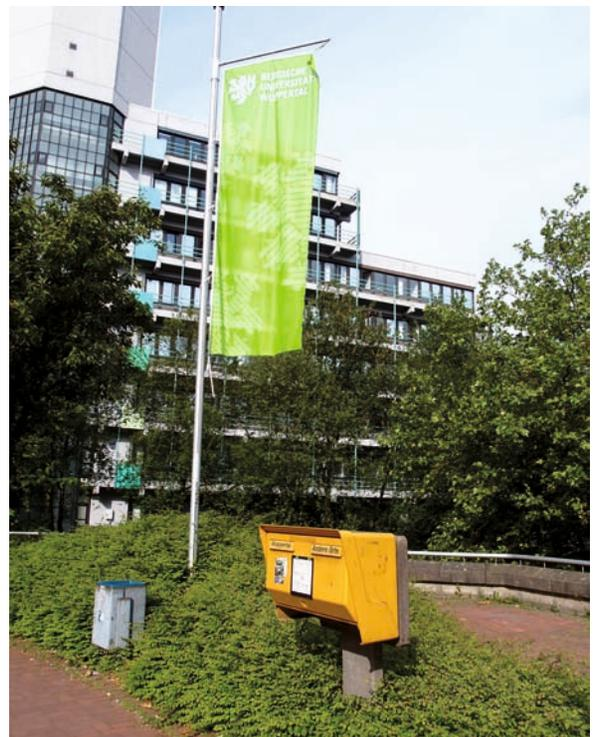
Das Problem der kontrastarmen Kombination von unbehandeltem Metall zu mittelhellen Bodenbelägen findet sich im Gehwegbereich auch häufig bei Ampel-, Laternen-, Schild- und Fahnenmasten. Abbildung 22 zeigt ein Beispiel zur kontrastreichen Absicherung von Fahnenmasten durch Begrünung am Fuß des Mastes mit niedrigen Hecken.
