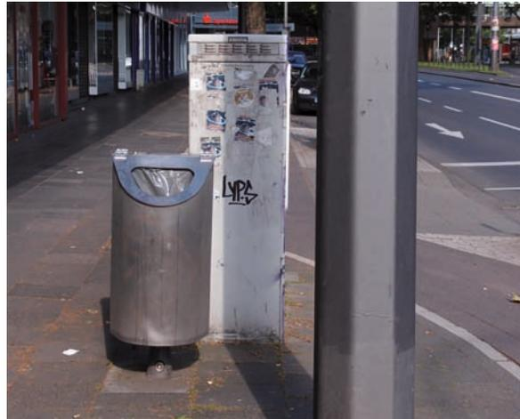
Die Leuchtdichten der einzelnen Elemente unterscheiden sich nur ungenügend von der Leuchtdichte des Bodenbelages und bergen Auflaufgefahren. Eine optische Absicherung durch eine kontrastreiche Markierung wäre auf allen Objekten mit Klebefolien oder Lacken oder durch Bodenindikatoren realisierbar.
