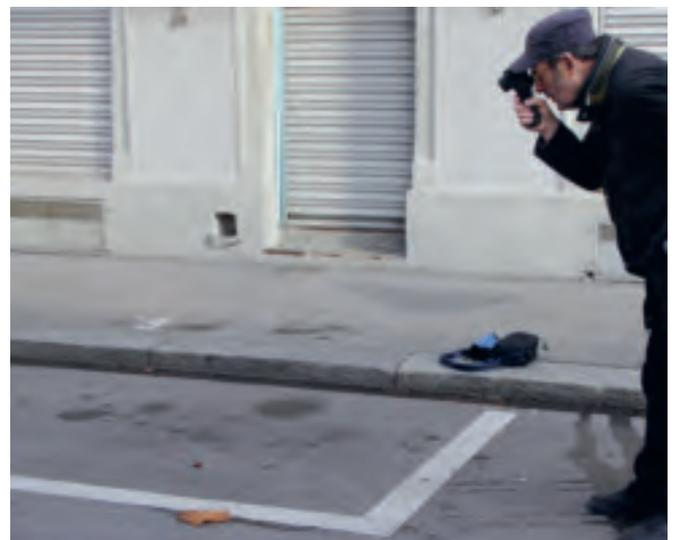
Mit dem Leuchtdichtenmessgerät werden aus der Perspektive des Betrachters die Leuchtdichten eines Objekts und dessen Umfeld gemessen.
