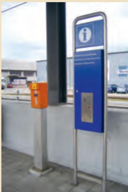
*Bedienungselemente wie Entwerter und Informationsstelen müssen auch unter Zeitdruck gut auffindbar sein. Die orangefarbenen Entwerter erfüllen diese Anforderung.*
