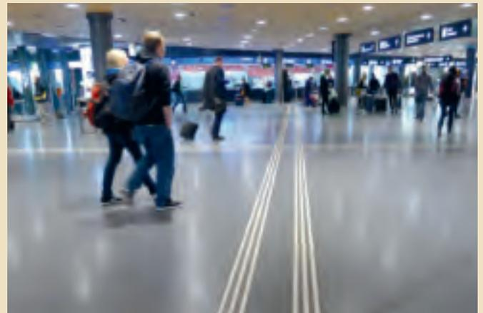
In der Bahnhofshalle des Flughafens Kloten führen die Leitlinien zu den Bahnperons, dem SBB-Schalter und zur Anmeldung für Flugreisende mit Behinderung.
