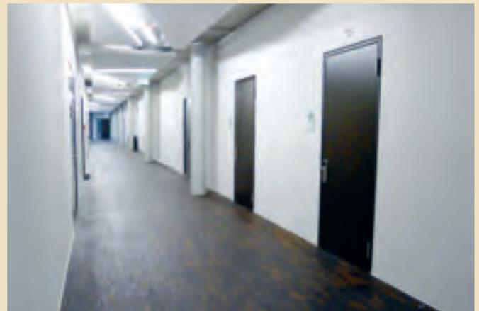
Ein guter Kontrast zwischen Boden und Wand sowie zwischen Wand und Türen erleichtert die Wegführung und das Auffinden der Räume.
